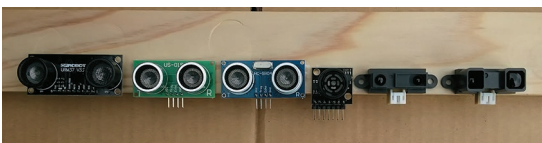
写真2 同一条件で計測できるようにセンサ6個を一列に取り付けた
