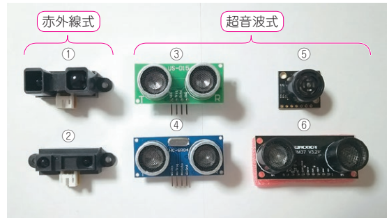
(b) 液面までの距離を検知するために用意したセンサ
