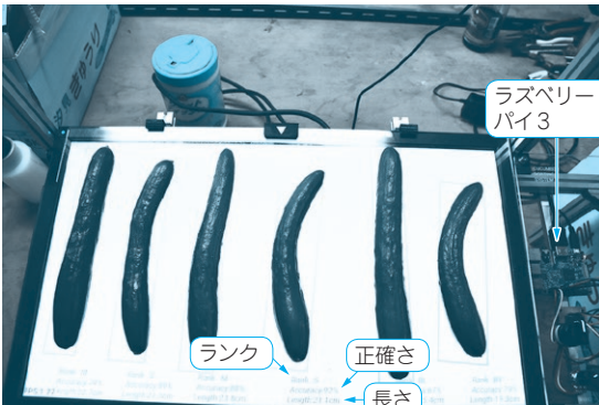
写真1 複数本置くだけでリアルタイムにジャンジャン選別してくれるAIテーブルを作る
