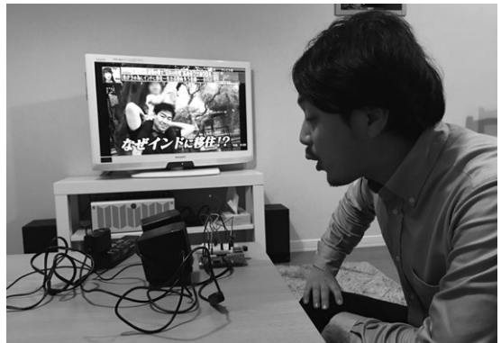
写真2 声でRaspberry PiのGPIOをON/OFFできるひとまずテレビのリモコンとして使った
