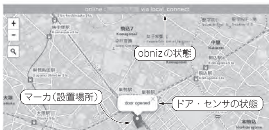
図1 センサの状態をオープンソース地図&amp;ライブラリを使って可視化する
