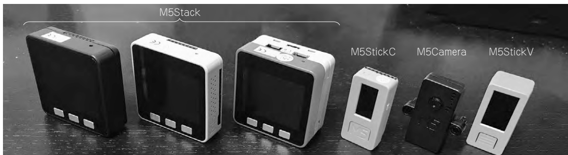
写真1 ESP32にLCD/操作ボタン/センサ/カメラを加えて手のひらサイズの箱に収めたキットM5シリーズ
