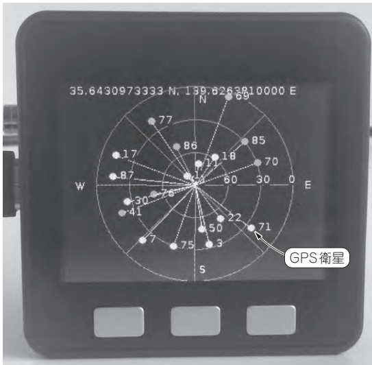
写真1 GPS衛星の現在位置を手のひらM5Stackに表示する もちろん現在地も表示できる
