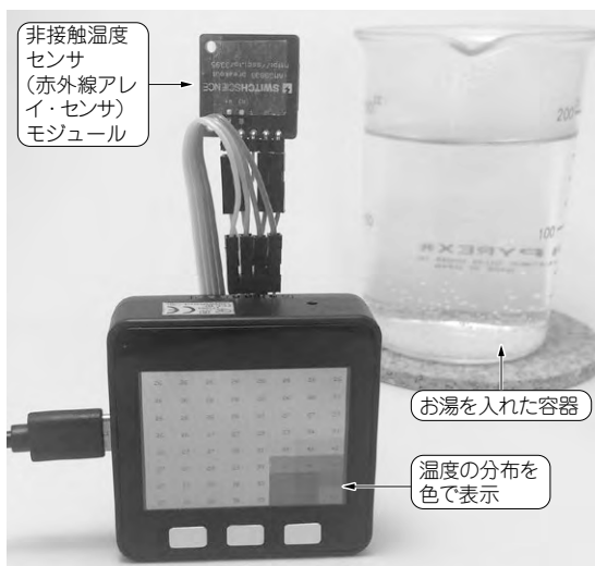
写真1 非接触で離れたところの温度を手のひらデバイスM5Stackに表示してサーモグラフィにする
