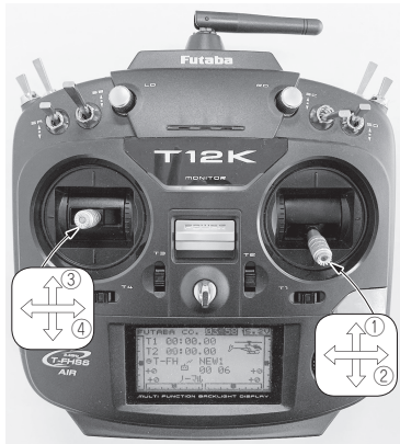
図5 プロポ (T12KH) の操作
