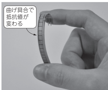
写真1 たたく/なでるを検出するための曲げセンサ
