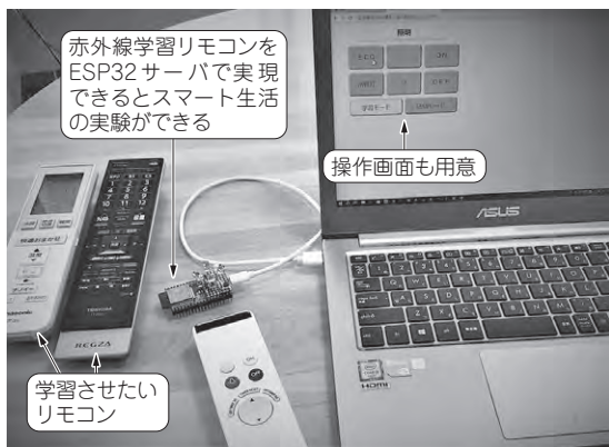
写真1 本章で製作するサーバ機能付きESP32赤外線学習リモコン「IRServer」
