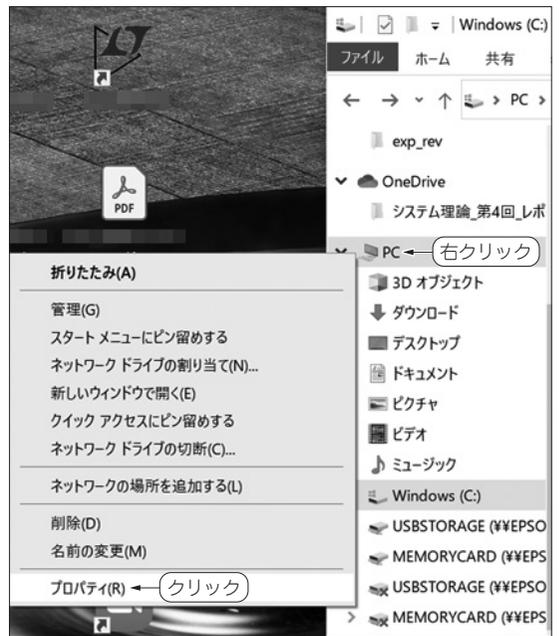
図9 ウィンドウ左カラムの「PC」上で右クリックして「プロパティ」をクリック
