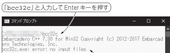
図14 コマンドプロンプトに「bcc32c」と入力後に上記のメッセージが表示されればOK
