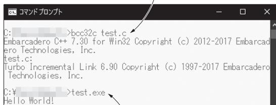
図15 test.cをコンパイルして実行ファイル「test.exe」を作成し、実行すると「Hello World!」と表示がでる
