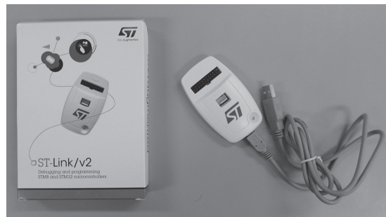
写真3 マイコンへのプログラム書き込みにはプログラマ/デバグであるST-LINK/V2が必要
