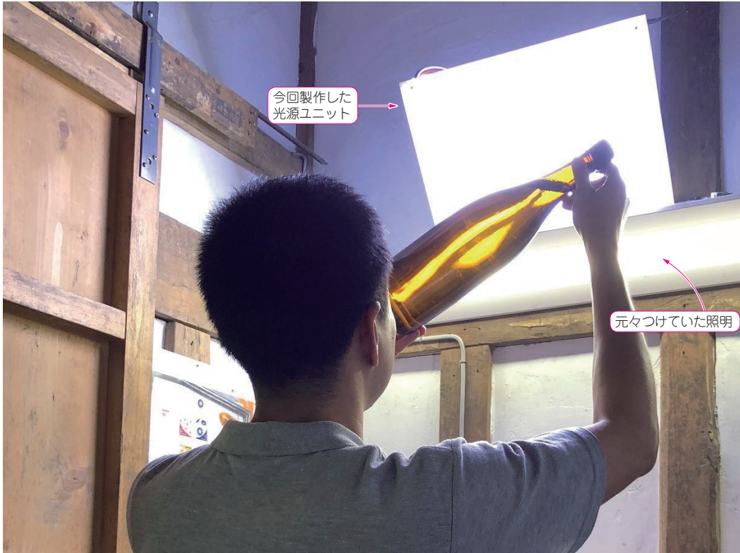
写真1 今回光源ユニットを作る…自動調光ライトが完成し室内で日本酒の目視検査ができるようになった
