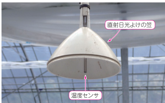
写真1 温室気温測定でよく使用されている笠付き温度センサ これでもある程度正しくは測れるがそれでも3℃くらいはズレしてしまう理由や対策を紹介する
