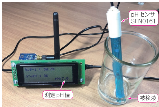
写真1 製作する pH 値測定・表示器
