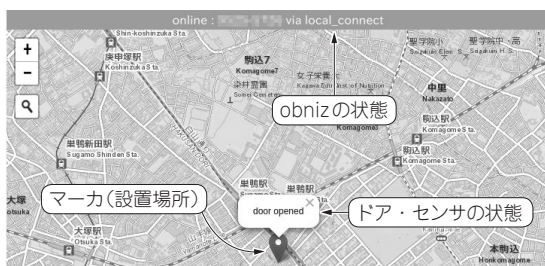
図1 センサの状態をオープンソース地図&ライブラリを使って可視化する
