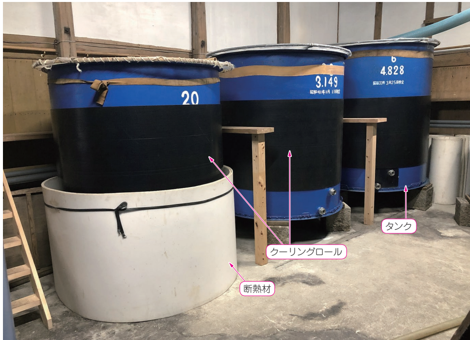
写真1 醸造できる期間を飛躍的に長くできるクーリングロール
