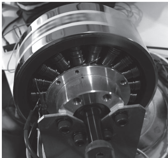
写真1 小型EVカート向けに開発されたCQブラシレス・モータを回す
