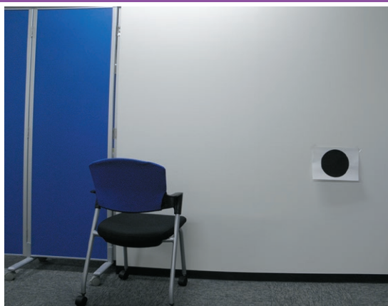
写真1 事前準備…サイズが既知の基準円を壁などに貼り付ける直径20cmの黒丸●
