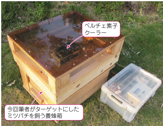
写真1 ペルチェ素子を使って温度センシング&冷却制御の実験を行う
