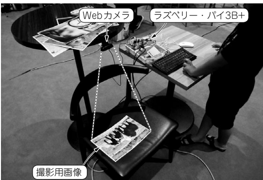
写真1 ラズベリー・パイに接続したWebカメラの画像から物体認識
