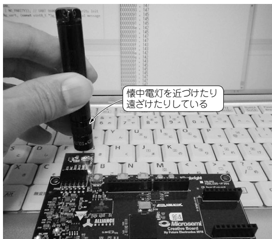
写真1 環境光センサを RISC-V 開発ボードから使う
