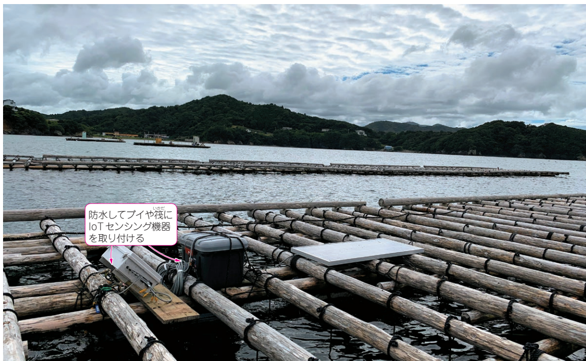
写真1 海のIoTはこれからのポテンシャル抜群…リモートで水温が測れるだけでものすごく便利になる IoT端末はブイや養殖筏 いかに などに取り付けることになるので防水、ワイヤレス通信、独立電源などが重要
