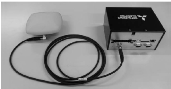
写真1 PPP-RTK方式対応の受信機(三菱電機)
