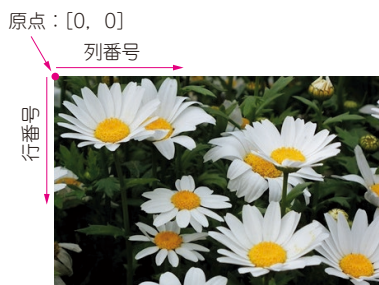
図1 OpenCVでは画像の左上を原点とする
