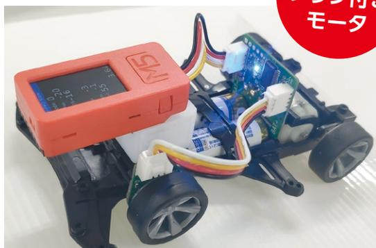
写真1 モータ制御用の基板をミニ四駆に追加する
