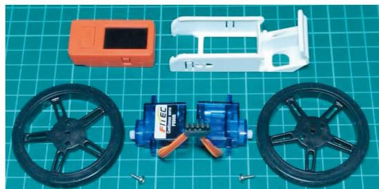
写真3 安価な部品だけで倒立振り子を作る
