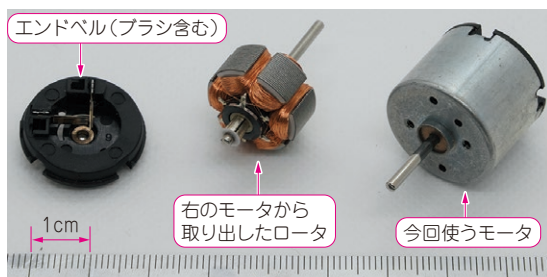
写真2 プロペラ駆動に使うモータ
