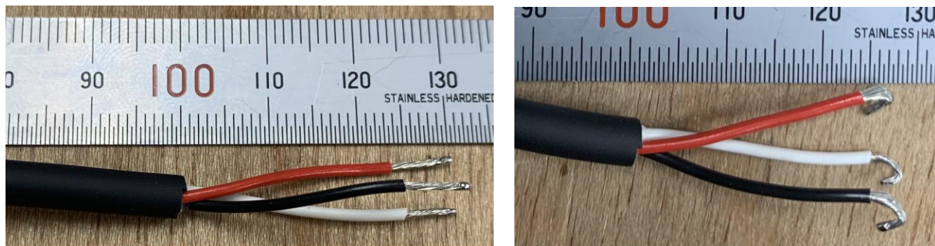
図 2-57 ボリュームに取り付けるケーブルの加工
