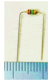
図 2-11 R51,R52,R63,R64,R73,R74 : 1MΩ 1/4W
