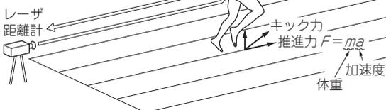
図2 レース中のランナまでの距離を正確に測れば「見えない推進力」が見える
