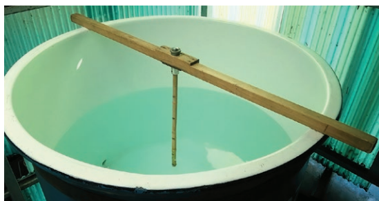
写真1 これまで木の棒の濡れ具合でタンク内のお酒の残量を計測していた
