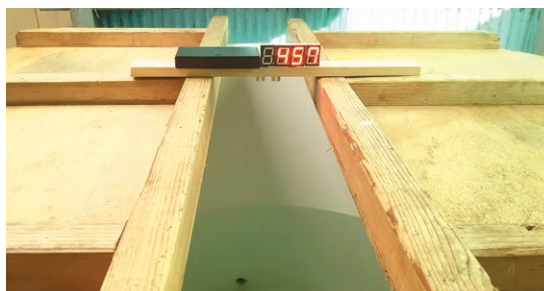
写真2 製作した超音波式の残量計
