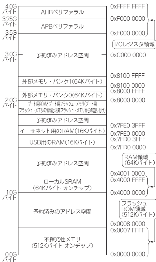
図1 LPC2388のメモリ・マップ [文献(3) UMI0211 LPC23XX User manual Chapter 2: LPC23XX memory addressingのFig10から引用]
