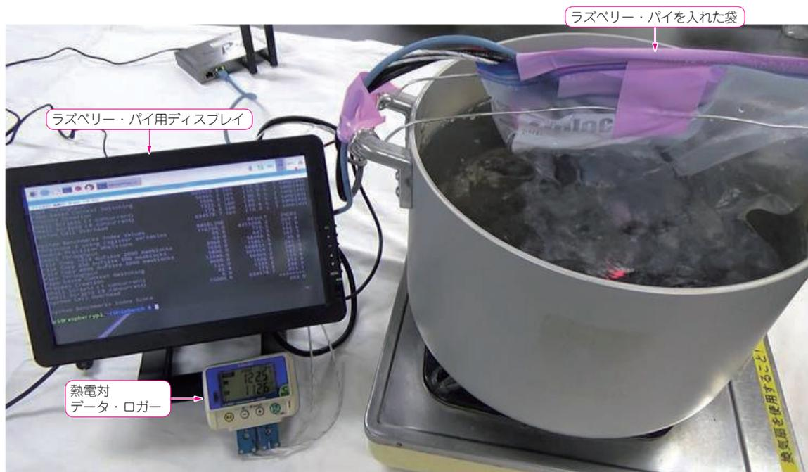
写真1 身近な設備で高温時の動作を確認するために稼働中のラズベリー・パイ3を鍋に入れて煮てみた
