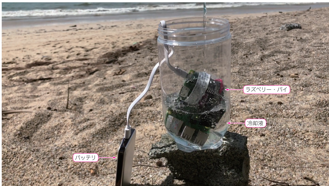
写真1 液冷を想定して液体に漬けながら動かしてみる
