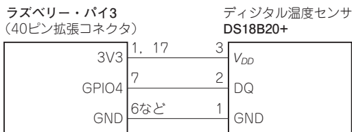
図2 ラズベリー・パイ3と温度センサとの接続
