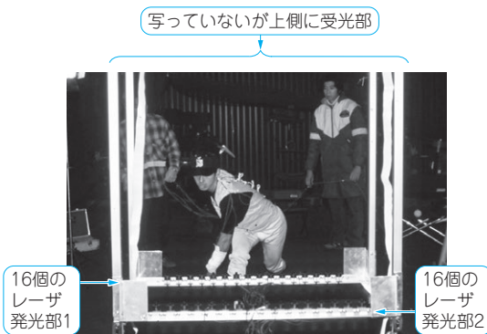
写真2 レーザ光のカーテンを自作して通過時間から球速を測る
