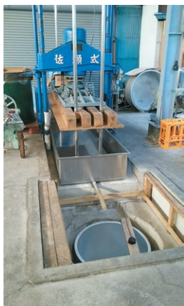
写真1 お酒を搾る機械「槽」 これは「佐瀬式」という縦方向に搾るタイプ
