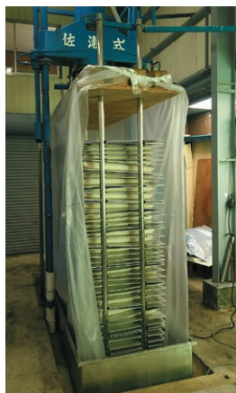
写真2 醪が入った状態の槽 一番上までは約2mくらいの高さになる
