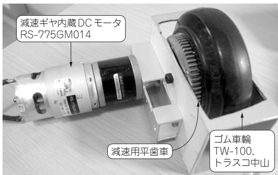
写真1 モータと減速用歯車と車輪を一体化して両側に取り付けるDCギヤードモータとゴム車輪の間に平歯車が入っている
