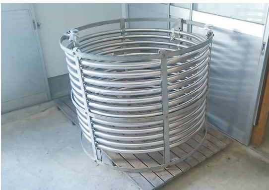
写真1 火入れに使う「蛇管」…これを和釜の中に沈めて使う
