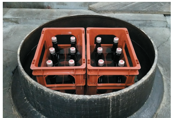
写真2 「瓶燗」の様子…和釜の中にお酒の詰まった瓶を直接入れる
