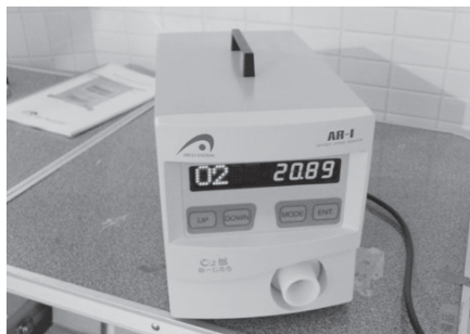
写真2 安静時代謝エネルギー測定器にはO 2 /CO 2 /圧力/温度/湿度センサが搭載されている ポータブル・ガス・モニタ AR-10 Type4。(有)アルコシステム
