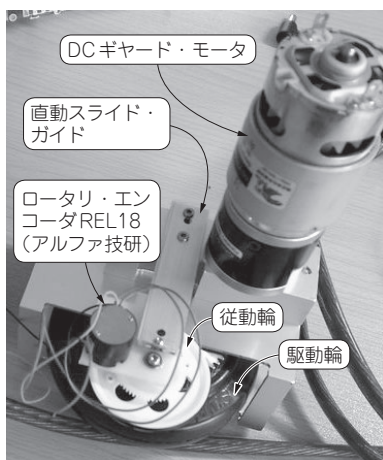
◀写真1 マブチ・カーの心臓部: 駆動モジュールにロータリ・エンコーダを取り付けた
