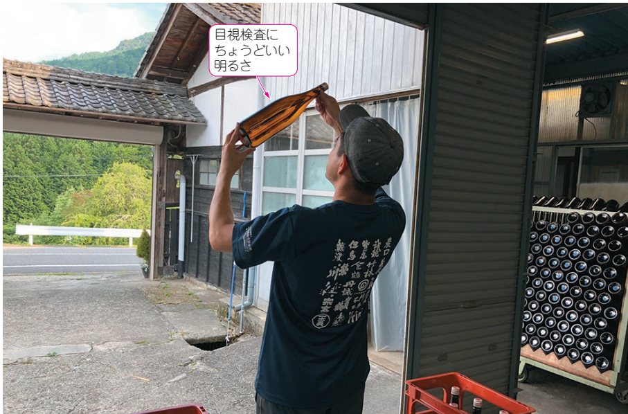
写真2 全数目視検査…日光に透かして異物混入のチェックを行う
