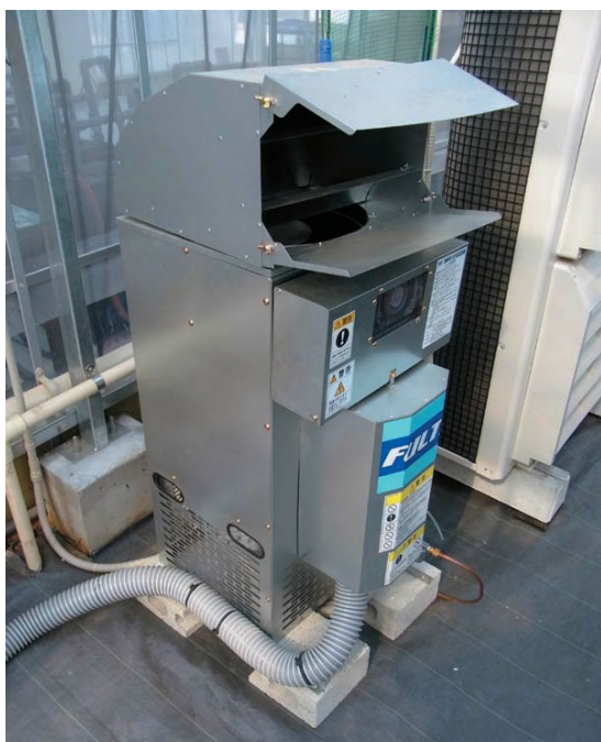
写真1 温室栽培では灯油などを燃やしてCO 2 濃度を積極的に上げる「CO 2 施用」が行われる
