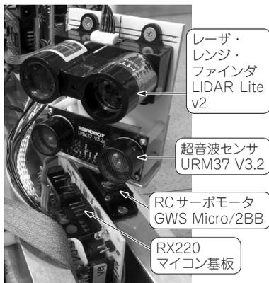
写真1 距離センサ・モジュール
