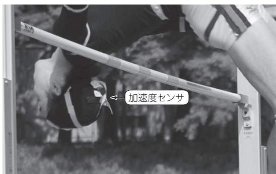
写真2 選手の後頭部に装着した加速度センサの値を解析してみる
