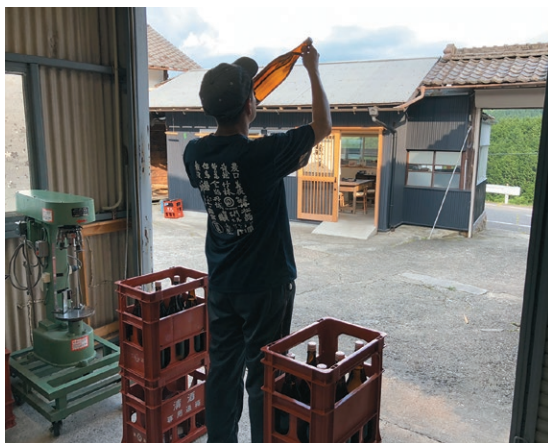
写真1 瓶を太陽光に透かして目視検査を行う…晴れていないときや夜でも行えるような自動調光ライトを自作する
