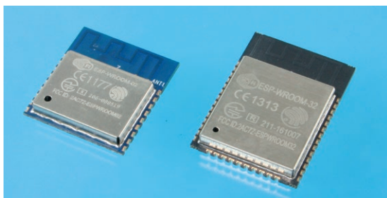
(a) 通称500円Wi-FiモジュールESP-WROOM-02 (b) 新500円Wi-FiモジュールESP-WROOM-32
