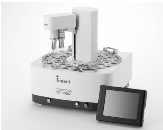
写真1 世界で初めての「味の物差し」味認識装置TS-5000Z インテリジェントセンサーテクノロジー製
