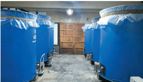
写真1 方法1：ホーロー製の常温タンクにお酒を貯蔵する 1本で約4000～5000リットルのお酒が保管可能
