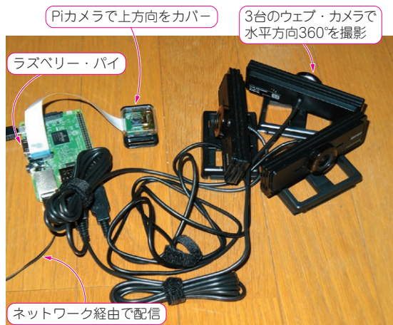
写真1 ラズベリー・パイで複数カメラを使った撮影術を紹介…今回は水平360°（全方位）を撮影する 4台のカメラの画像を1枚にまとめてH.264動画としてネットワーク経由で他のPCへ配信する
