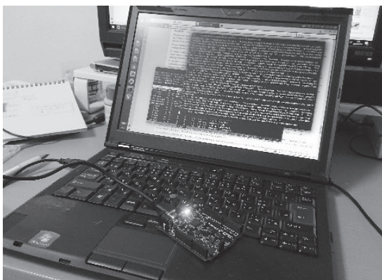
写真2 ここでやること…RISC-Vマイコン評価ボードHiFive1を動かして実力を確かめる
